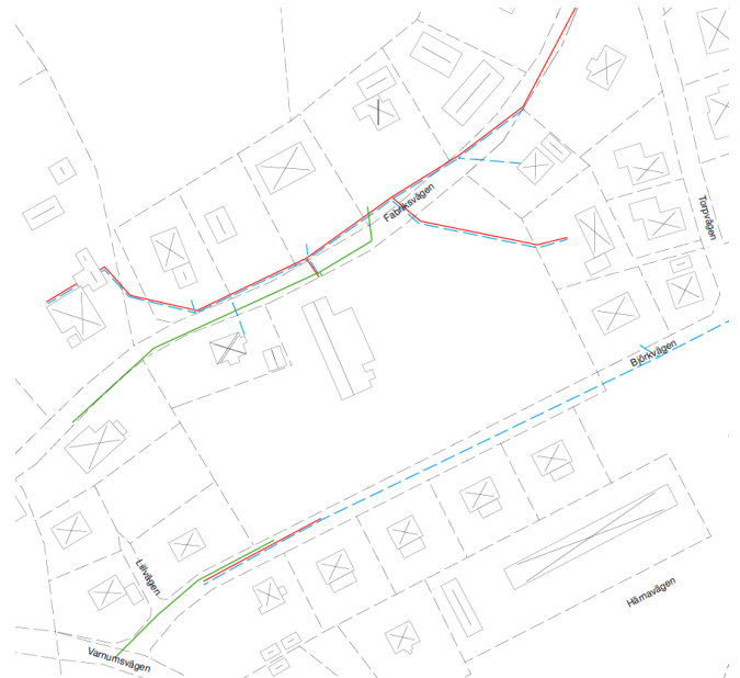
Bild 4. Ledningar i området. Röd=avlopp, blå=vatten och grön=dagvatten
