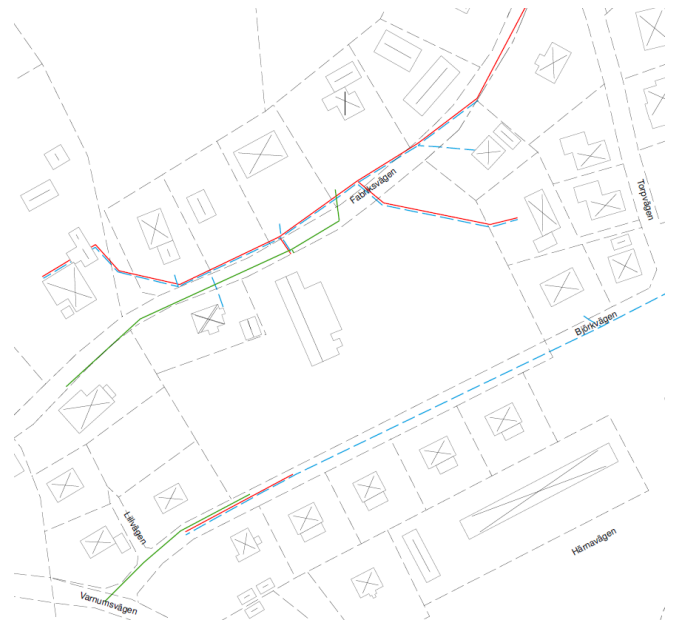
Bild 5. Ledningar i området. Röd=avlopp, blå=vatten och grön=dagvatten
