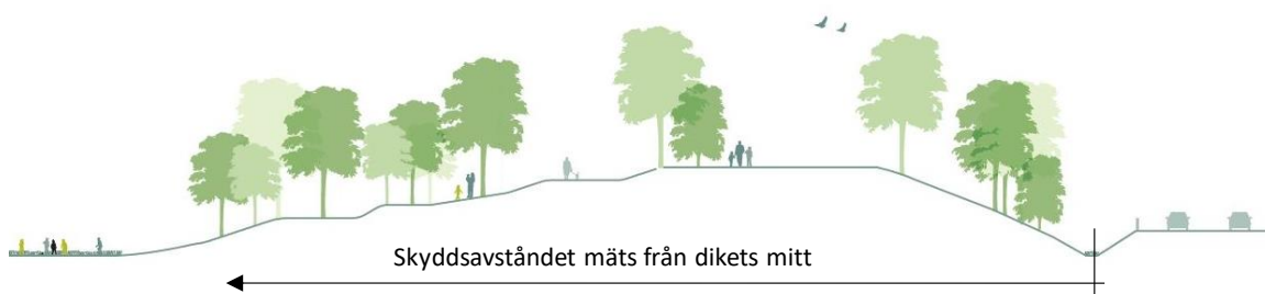
Figur 32. Illustration av hur angivet skyddsavstånd ska mätas då det finns dike.
