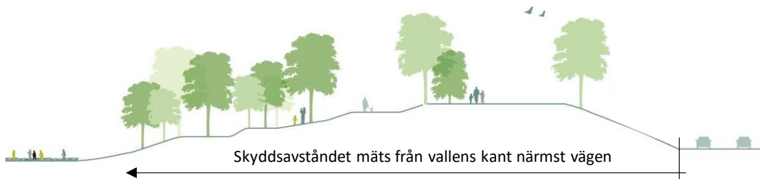
Figur 31. Illustration av hur angivet skyddsavstånd ska mätas då det finns en vall. el. dyl. mot transportleden.
