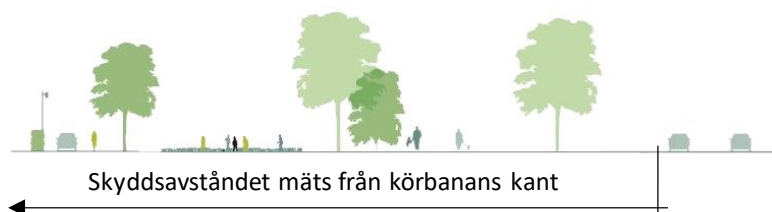
Figur 30. Illustration av hur angivet skyddsavstånd ska mätas med undantag då vall el. dyl. används.
