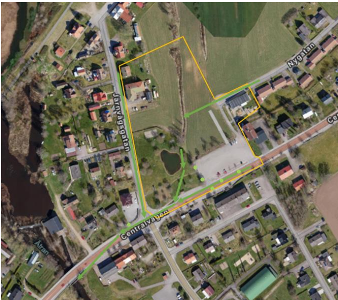
Figur 5 Planområdet är markerat med gula linjer. Dagvattennätets placering och riktning är markerat med gröna pilar och rännstensbrunnarna är markerade med gröna prickar (Lantmäteriet, 2022-09-09).
