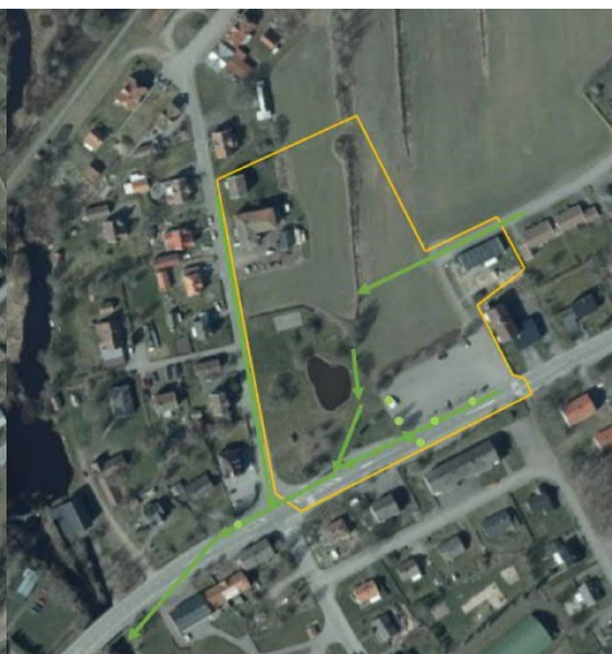
Figur 11 Dagvattennätets placering och riktning är markerat med gröna pilar och rännstensbrunnarna är markerade med gröna prickar.
